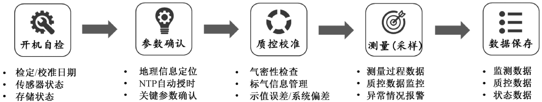
图3 现场监测仪器数字化功能
